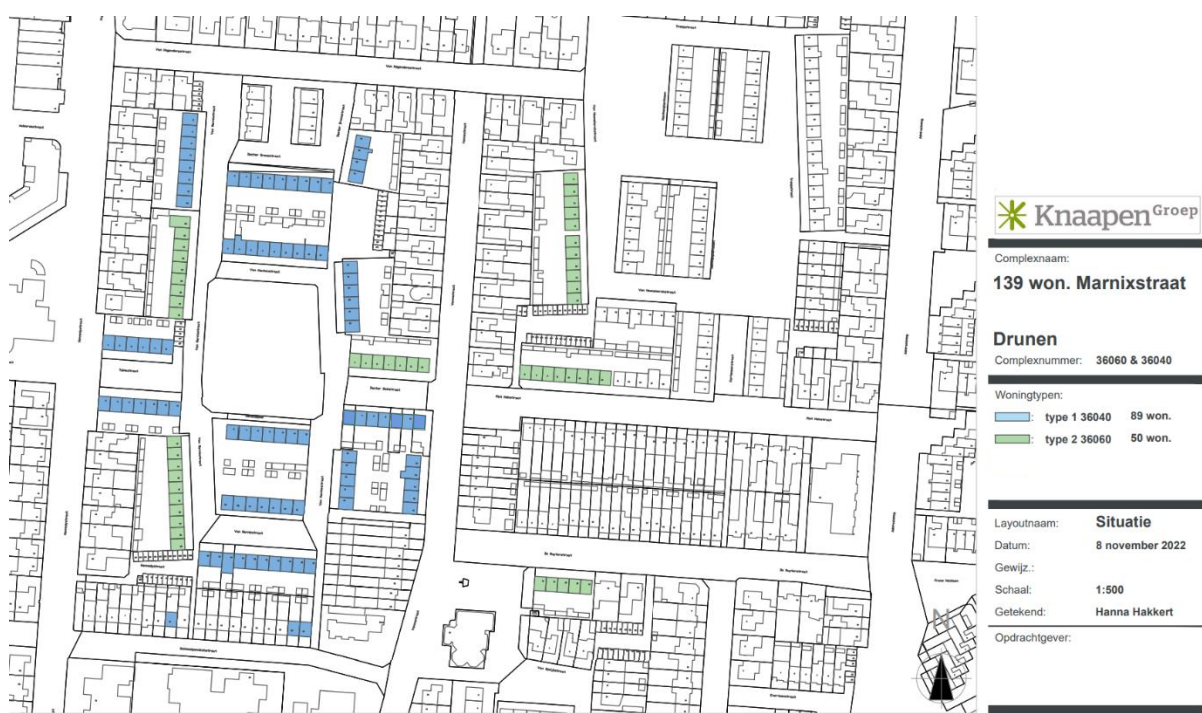
Figuur 2. Woningen worden in twee fasen gerenoveerd. Fase 1 = groen, Fase 2 = blauw. © Knaapen Groep. 2022
